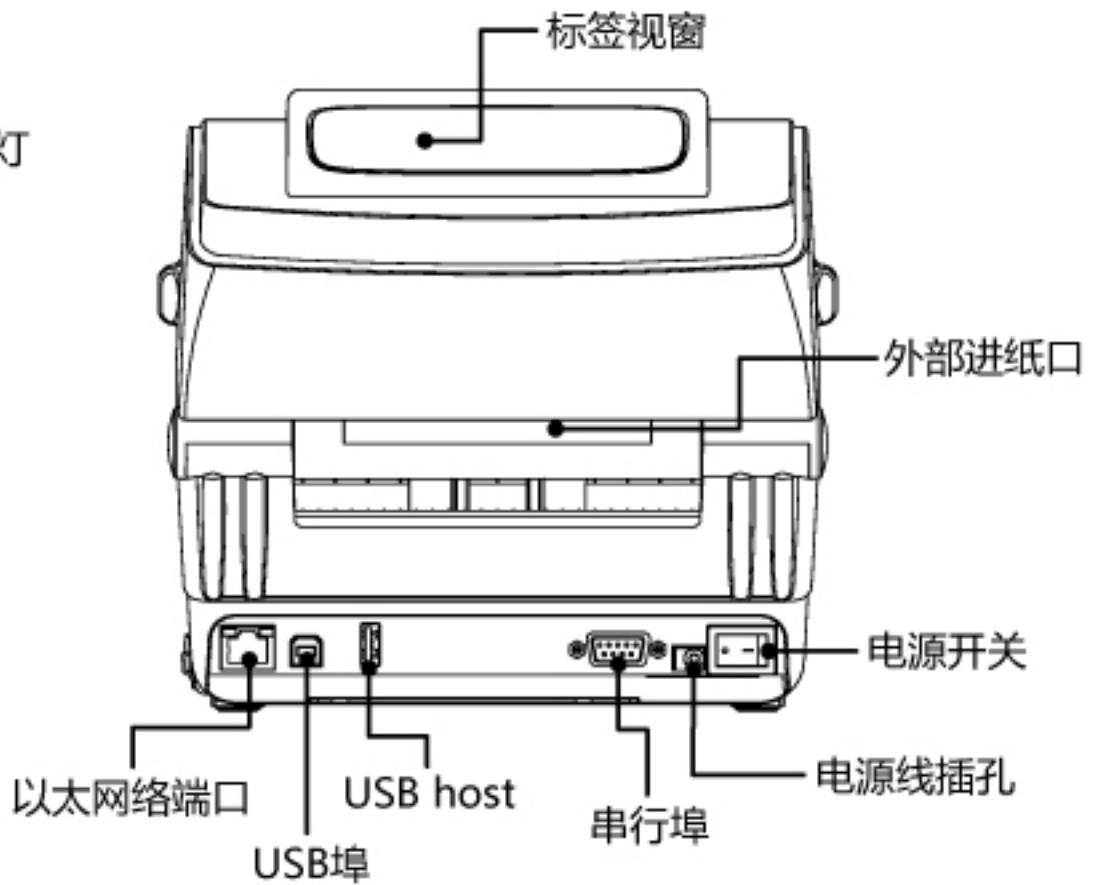
注意: 图片中打印机的传输接口会依据您所购买的机种类型而有所差异, 实际传输接口请参考产品型录规格。
